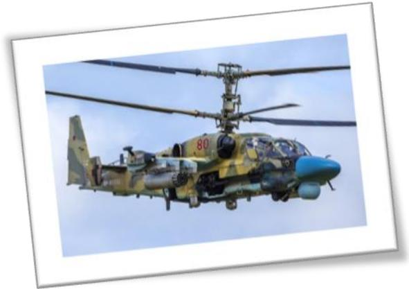
3) Вертолёт – винтокрылый 4) летательный аппарат вертикального взлёта и посадки, у которого подъёмная и движущая силы на всех этапах полёта создаются одним или несколькими несущими винтами с приводом от одного или нескольких двигателей.
